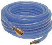
**Werkstoffe:** Schlauch: PVC-Innen- und Außenseele mit Textil-Gewebeeinlage in Lebensmittelqualität, TÜV-geprüft, silikonfrei, Kupplungsdose und Kupplungsstecker: Messingkörper mit NBR-Dichtungen
